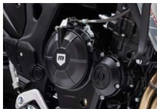
MOTOR BICILÍNDRICO DE 4 TEMPOS, 8 VÁLVULAS, 498CC. / EMBRAIAGEM DESLIZANTE
